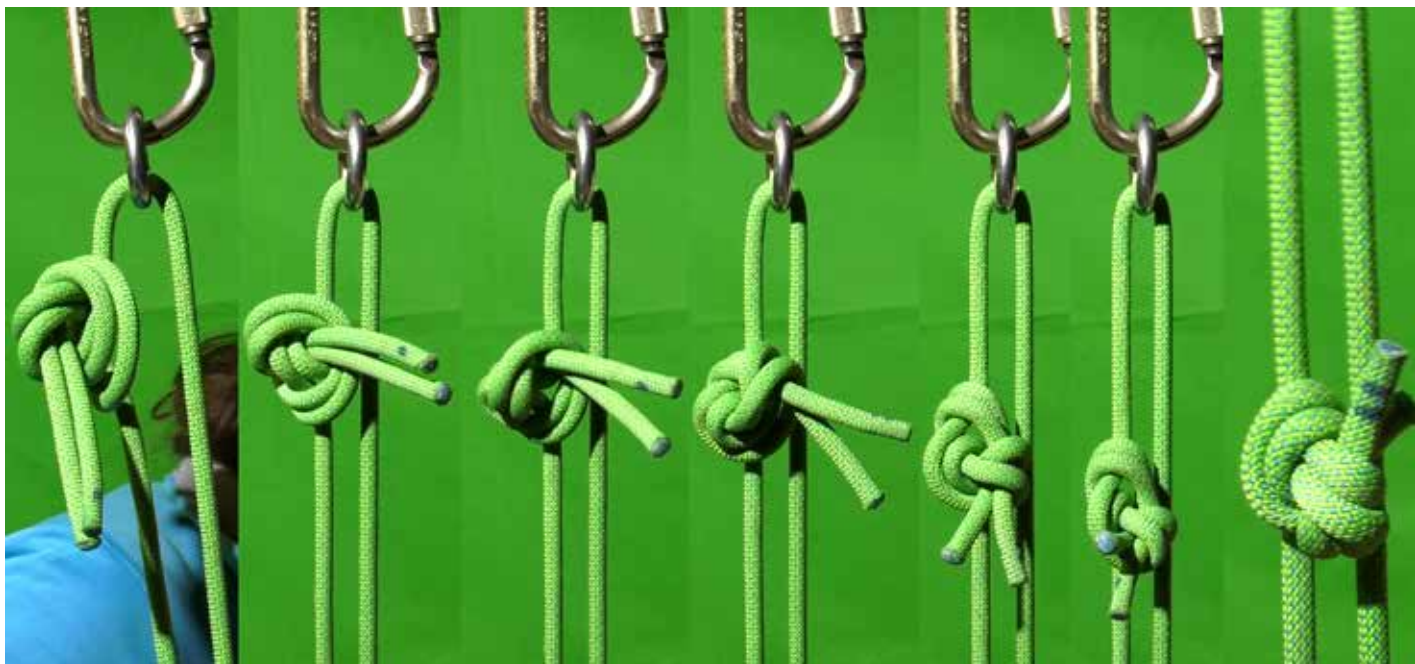
Figure 13: une prise en charge de rappel progressive sur deux brins de corde opéra reliés par un nœud de huit non serré, puis deux descentes rapides avec arrêt brutal
