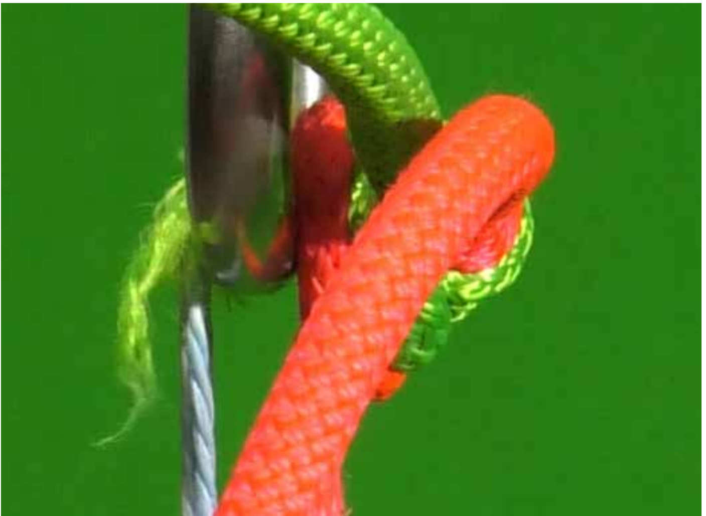
Figure 1: test de résistance d'un rappel fermé par nœud en huit de plein poing avec une corde Gully. La gaine s'est arrachée vers 1300 daN et la corde s'est cassée au niveau du nœud aussitôt.
